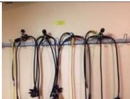
Détendeurs en octopus pour des plongées à 12m.
